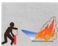
Nel caso di combustibili solidi l'angolo d'impatto deve risultare più accentuato per migliorare la penetrazione della polvere estinguente all'interno delle zone di reazione. In ogni caso si dovrà prestare attenzione perché l'effetto dinamico dell'estinguente potrebbe causare la proiezione di parti calde e infiammate generando la nascita di altri focolai.
